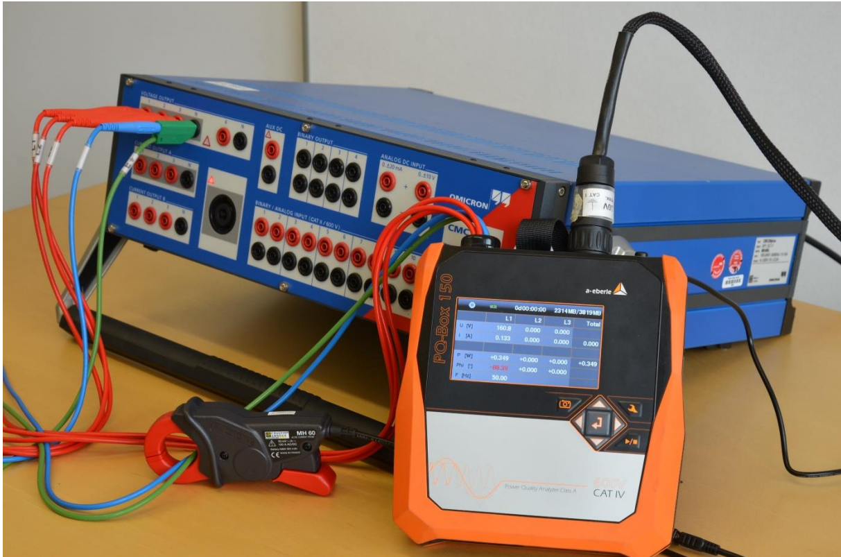
Abbildung 2. Prüfaufbau zur Verifikation der Genauigkeit einer PQ-Box 150 von a.eberle mit dem OMICRON CMC 256 plus
