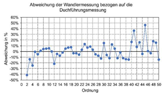
Bild 10 Abweichung der Messung über den Spannungswandler bezogen auf die Messung über die Durchführung
